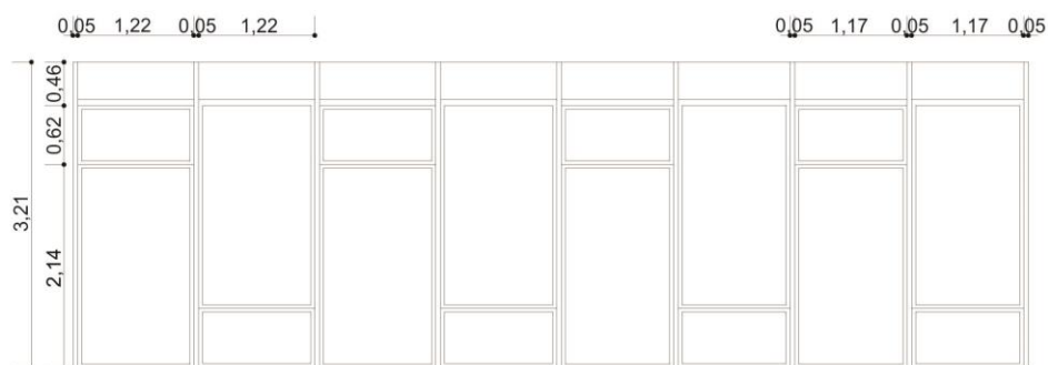
Figura 35 - Anexo 1 do Senado Federal, fachada norte. Modulação do pano de vidro. À direita, módulo padrão, com 4,92m; à esquerda, módulo da extremidade, com 5,09m (BRASIL. SENADO FEDERAL, 2013).
